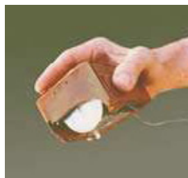
Der erste Maus-Prototyp von Douglas C. Engelbart
